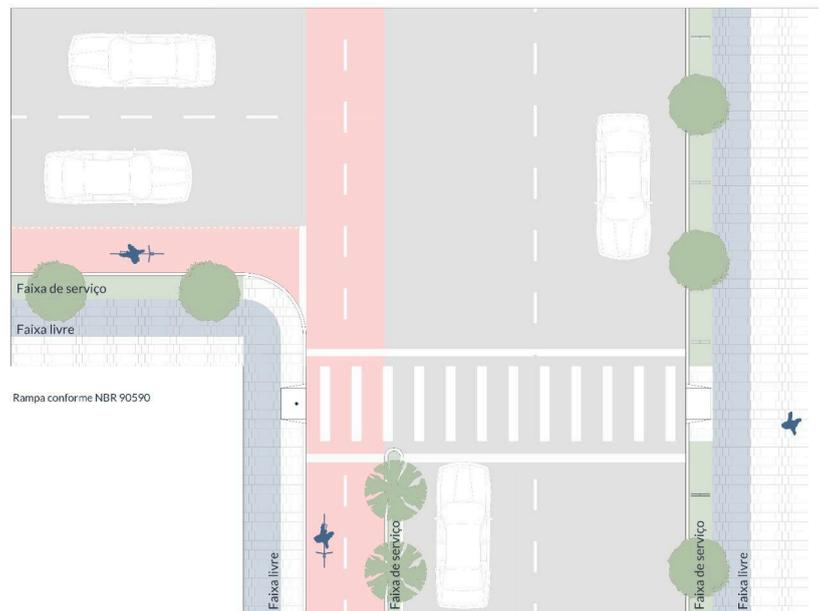
Esquinas – **Via estrutural** com ciclovia e **via conectora** com ciclofaixa
