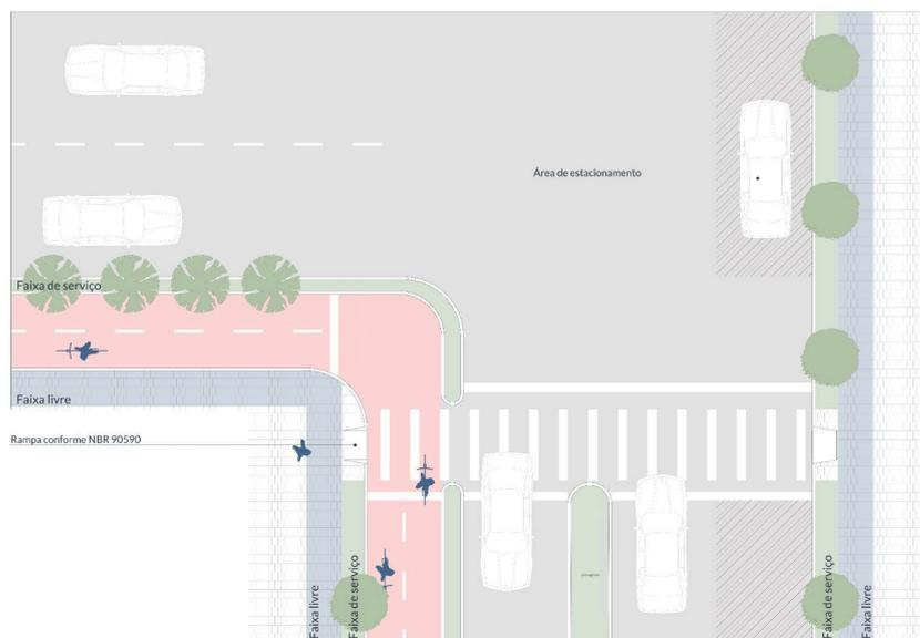
*Esquinas – **Via estrutural** e **via conectora** com canteiro, ambas com ciclovia*
